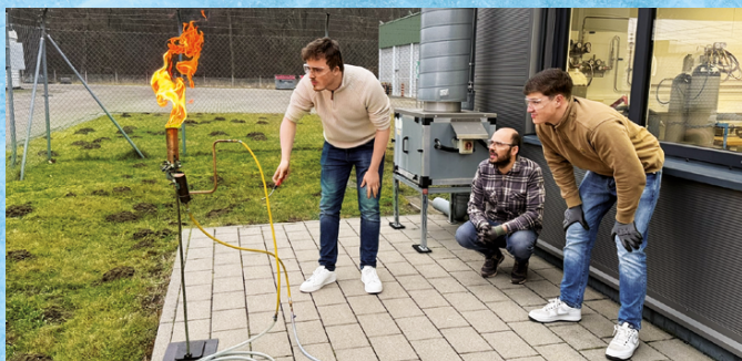
Zündgefahr beim Evakuieren eines R290-Kältemittelkreislaufs
