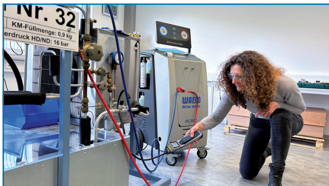
Überprüfung eines Kfz-Modells mit einem elektronischen Lecksuchgerät
