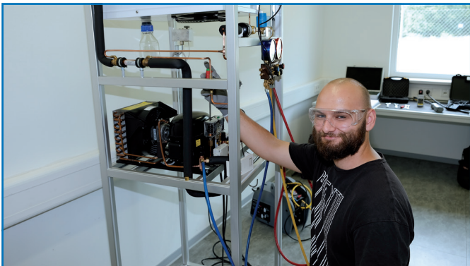
S. Neumann verstellt einen Druckschalter für das Labor „Fehlersuche“
