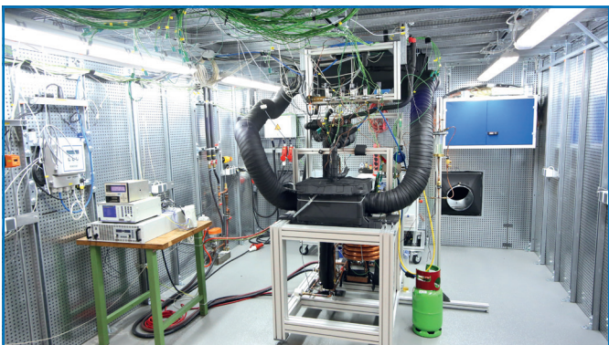
Kammerprüfstand zur Messung von kältetechnischen Kfz-Komponenten
