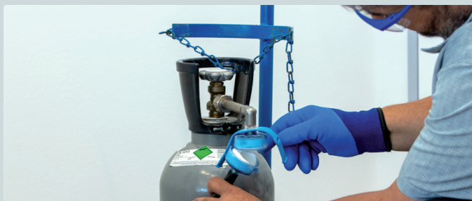
Erzeugung von Trockeneis durch Entnahme von CO 2 aus der Gasflasche
