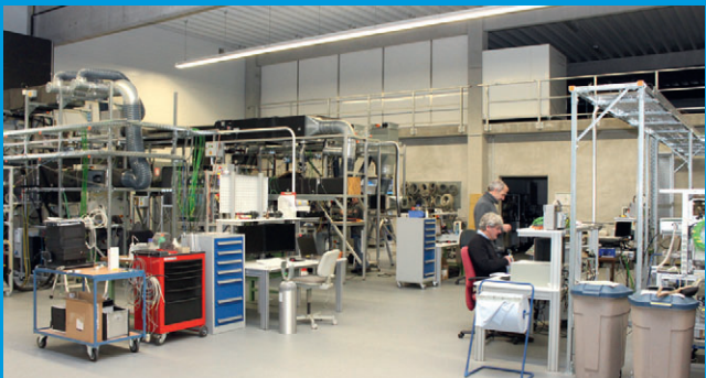
Leistungsprüfstände zur Untersuchung an Komponenten von Kfz-Klimaanl.
