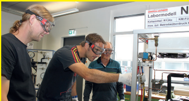
Übungen zum Befüllen und Evakuieren von Kälteanlagen an einem Modell
