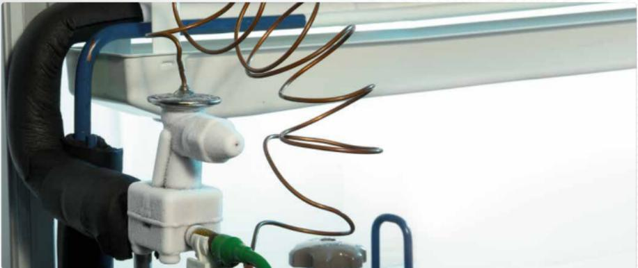
**Bild 7.** Mit Reif überzogenes Expansionsventil an einer Versuchskälteanlage
