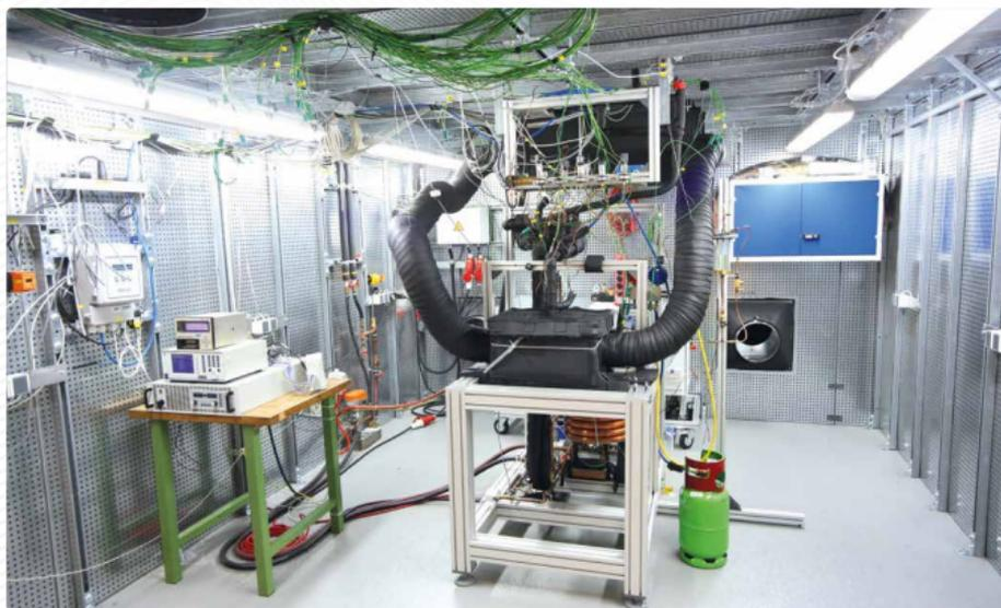
**Bild 13.** Messungen am Klimakasten einer Pkw-Klimaanlage im Prüfraum
