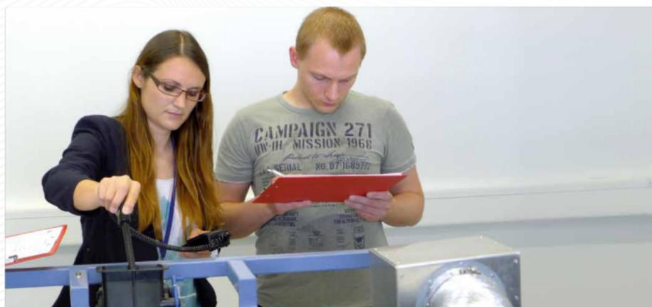
**Bild 11.** Messungen der Luftaustrittstemperatur an einer Pkw-Klimaanlage
