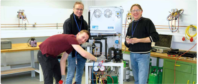
Bild 5. Evakuieren und Befüllen von Kältemittel an einem Labormodell
