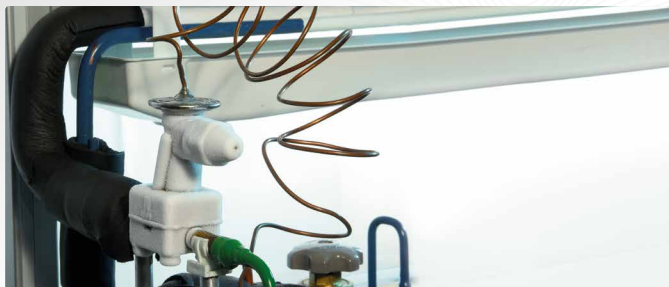
Bild 4. Mit Reif überzogenes Expansionsventil an einer Versuchskälteanlage
