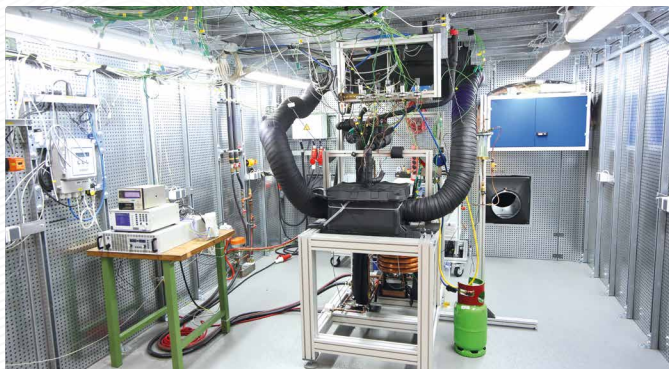
Bild 13. Messungen am Klimakasten einer Pkw-Klimaanlage im Prüfraum
