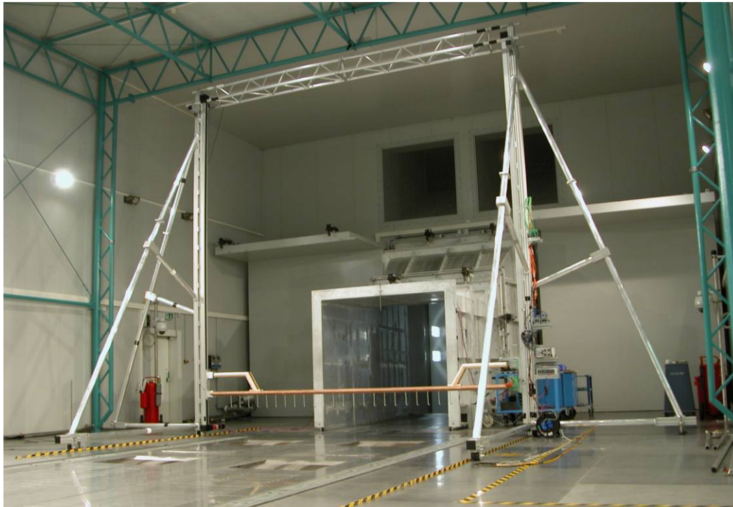
Bild 14: Kalibriereinrichtung mit Staudrucksonden und Temperatursensoren
