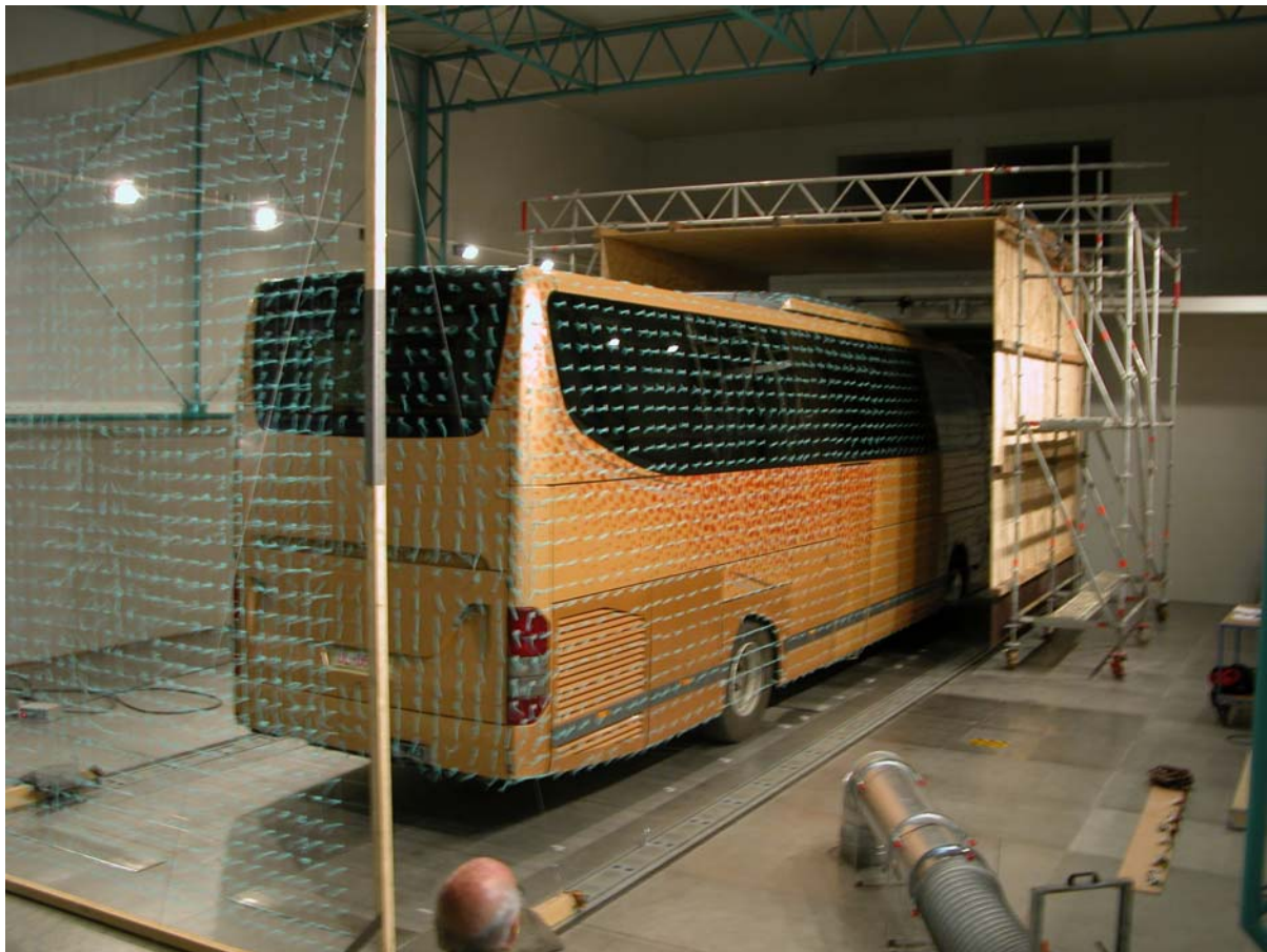
Bild 10: Bus im Windkanalplenum mit zusätzlicher Luftführung im Frontbereich
